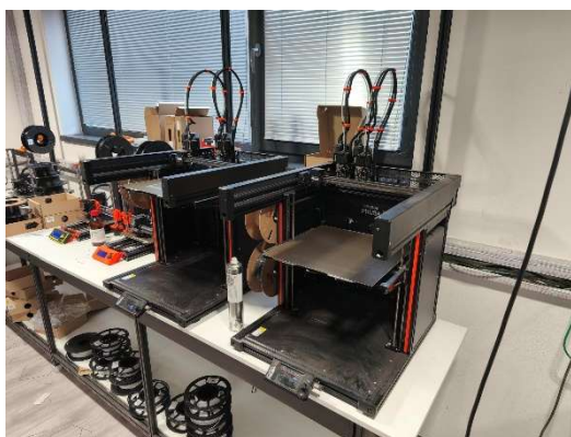
Obr. 16 Original Průša XL (vlastní pořizování, 2025)
