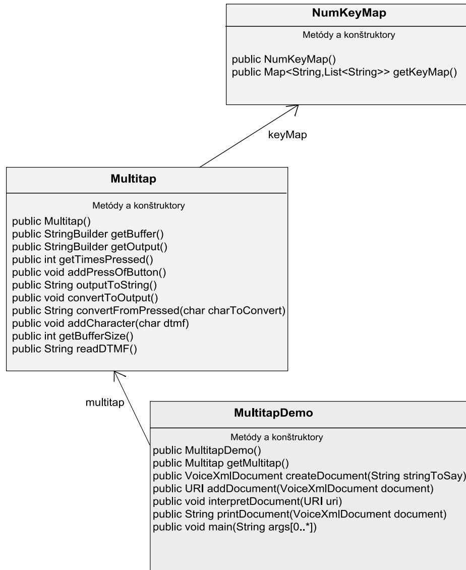
Obr. 5.1: UML diagram modulu a demo aplikácie
