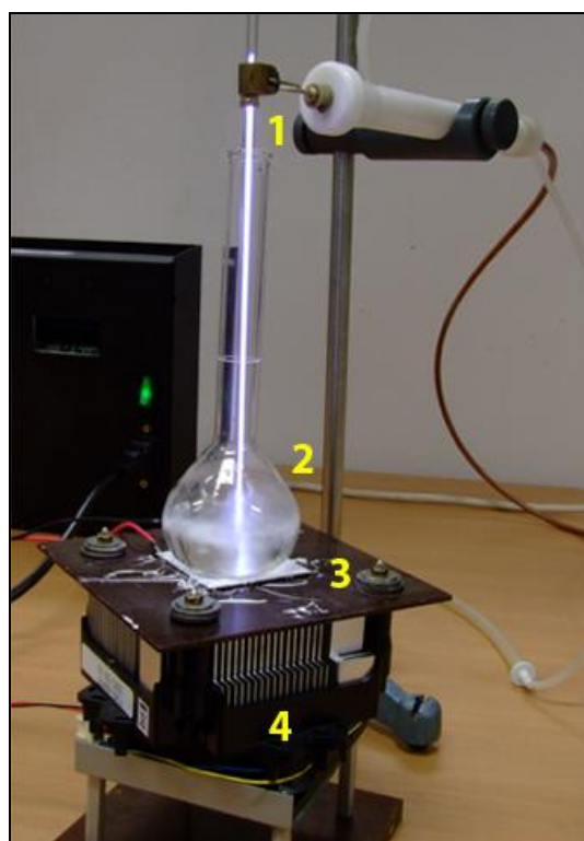
Obr. 3.08 : 1- vf výboj, 2-bakteriální suspenze, 3-Peltierův článek, 4-chladič s ventilátorem
