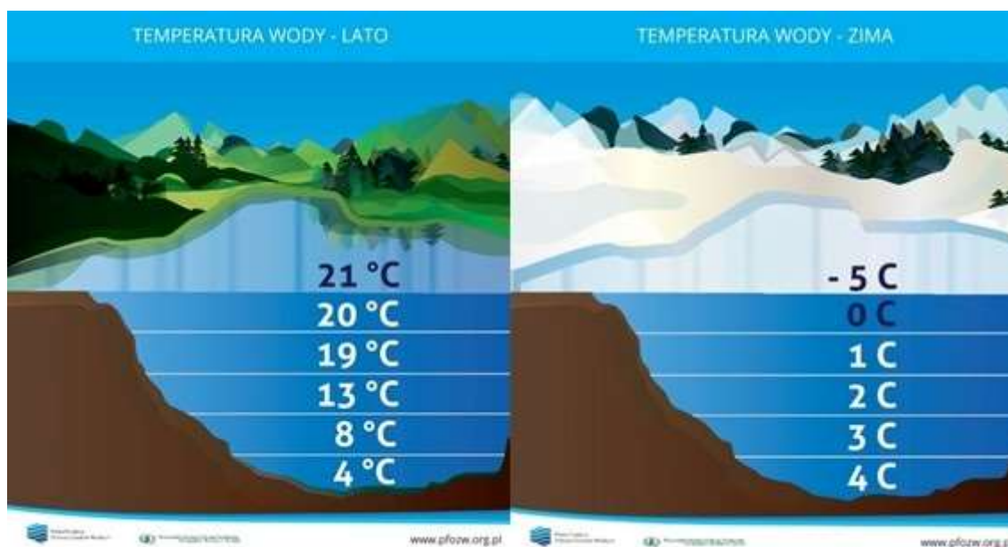
Obr. 31: Rámcové zobrazení teplotních rozdílů v létě a v zimě (mocnosti vodních sloupců mezi termoklinami nejsou zohledněny). 43
