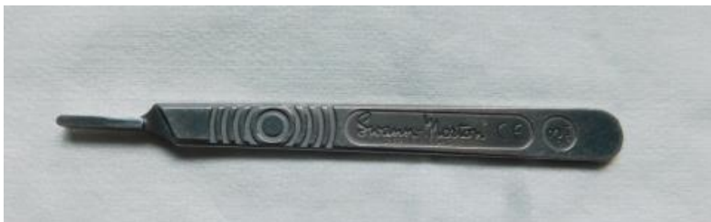
Obr. 51: Násada na skalpel, použití: k seřezání kůže
