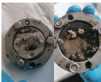
Obrázek 48: Poškození vrstev vzorkovačů, vlevo vidíme protržení předfiltru, napravo naopak vrstvu biofilmu
