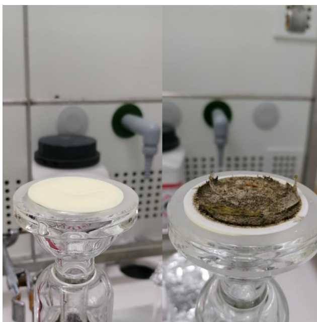
Obrázek 26: Čistý sorbent připravený pro profiltrování vzorku vody (nalevo), znečištěný filtr poté, co byl profiltrován vzorek vody (vpravo)
