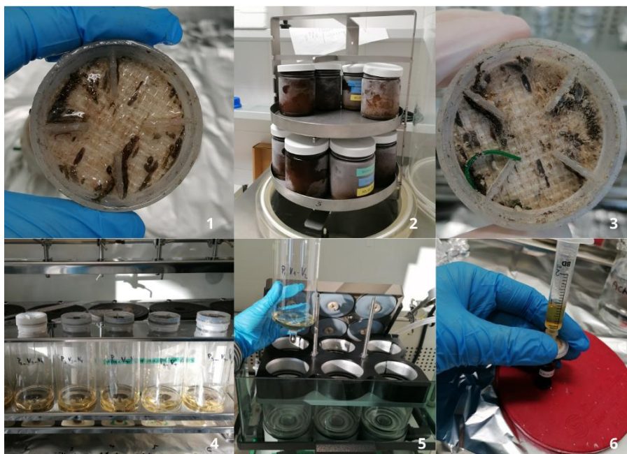
Obrázek 22: Zpracování speedisků – (1) – exponované speedisky, (2) speedisky ve vzorkovnicích před lyofilizací, (3) speedisk po lyofilizaci, (4) extrakce rozpouštědly, (5) zakoncentrování na Buchi Syncore, (6) finální vzorek
