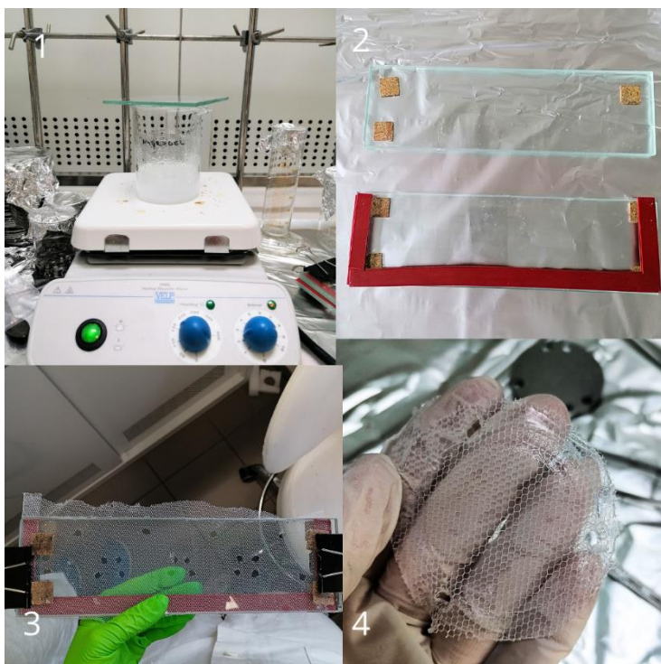
Obrázek 19: (1) příprava hydrogelu s pomocí magnetické míchačky (2) forma na hydrogel s gumovými mezerníky (3) hydrogel zalitý ve formě se sítinou (4) hotový hydrogel
