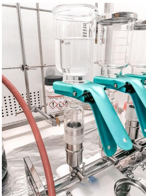
Obrázek 25: Vzorek vody, který protéká přes Affinisep disk pro extrakci analytů
