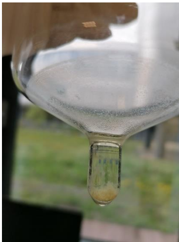
Obrázek 31: Částice na dně Syncore zkumavky, které se uvolnily z Affinisep disku
