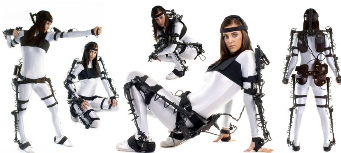
Obrázek 3.1: Moderní mechanický systém snímání pohybu Gypsy6. Převzato z 3 .
