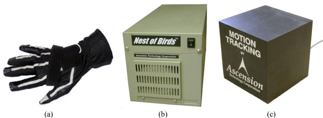
Obrázek 3.2: (a) Pinch Gloves, (b) řídicí jednotka, (c) generátor DC magnetického pole. Převzato z [16].
