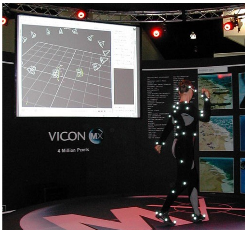
Obrázek 2.1: Optický systém snímání pohybu společnosti Vicon. Převzato z [04].
