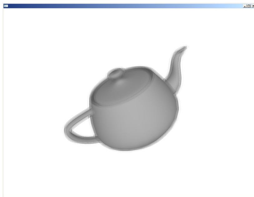
Obrázek 6.7.2 Rozostření pomocí post-processingu
