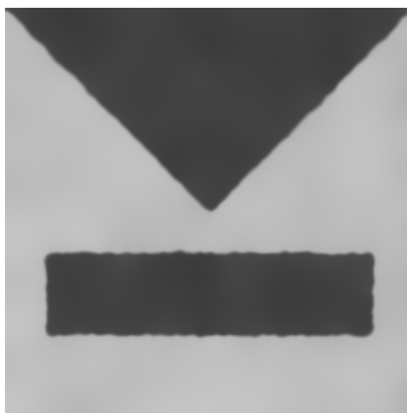
Obrázek B.12: odstranění šumu anizotropní difúzí \tau_\sigma = 1.0, n_\sigma = 1, \tau = 3.0, n = 20, \lambda = 5.0
