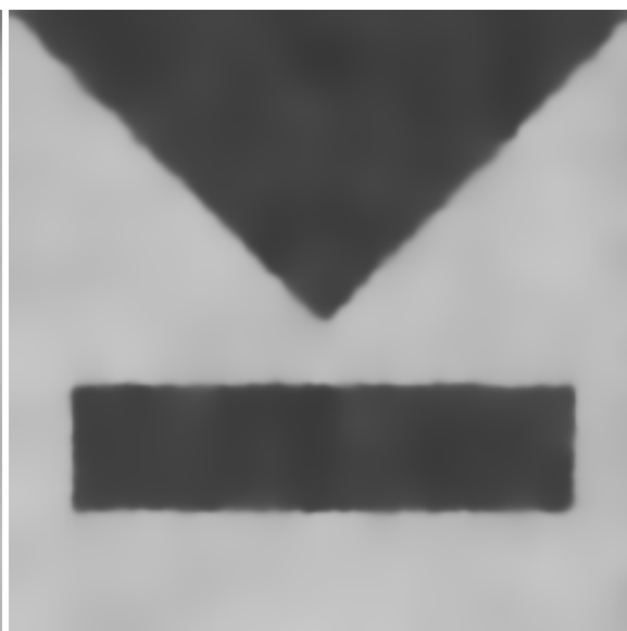
Obrázek B.11: odstranění šumu izotropní difúzí \tau_\sigma = 1.0, n_\sigma = 1, \tau = 3.0, n = 20, \lambda = 5.0
