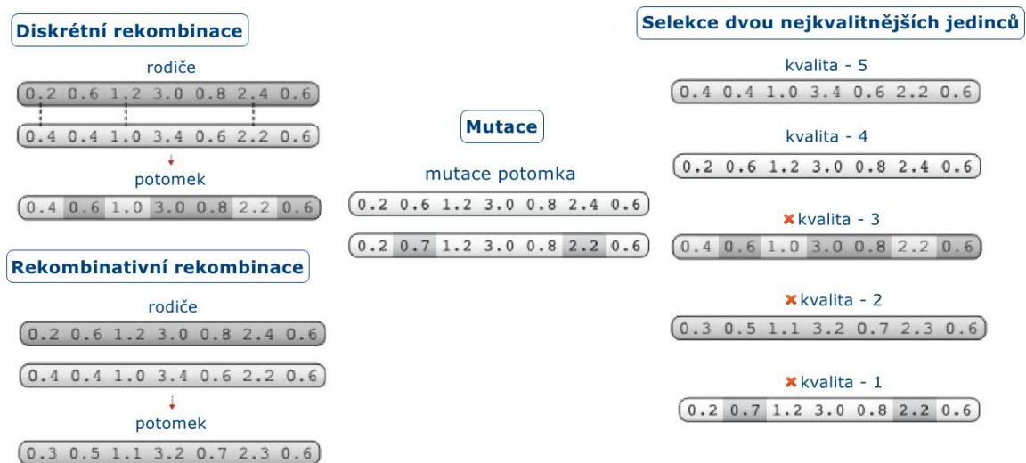
Obrázek 4.3: Schéma operací rekombinace, mutace a selekce u ES. U Evolučních strategií jsou jedinci reprezentováni řetězcem reálných čísel o dané délce. zdroj: (Floreano – Mattiussi, 2008), upraveno
