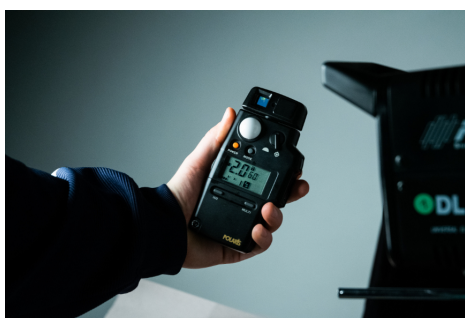
Měření expozičních hodnot expozimetrem Fomei Polaris
