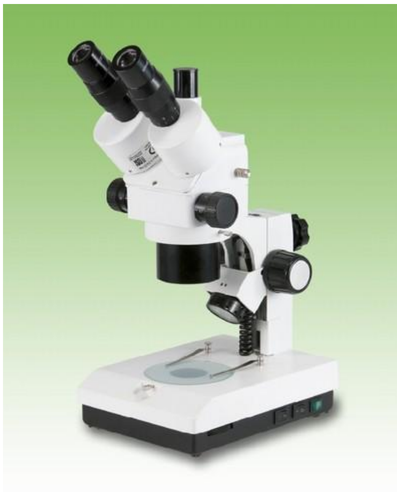
Obr. 6: Stereomikroskop s odraženým světlem Intraco Micro STM 723 3223 [20].
