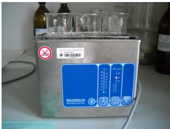
Obr. 4: ultrazvuková lázeň DT 31H [18].
