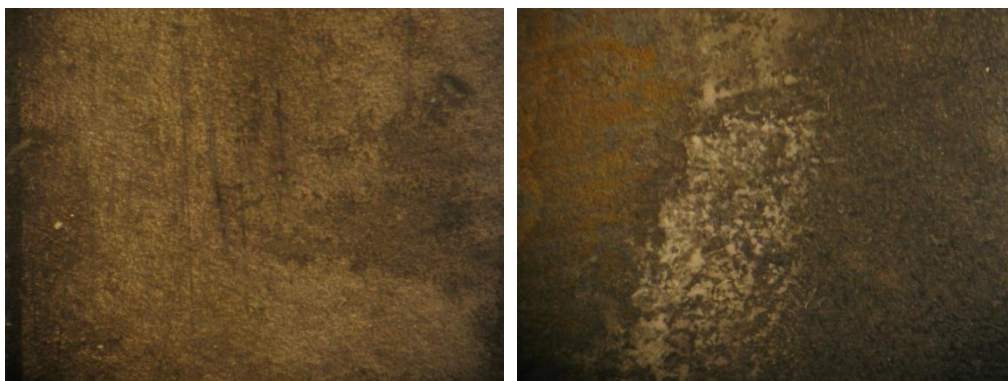
Obr. 55: Vzorek A po 15 minutách v ultrazvuku.
