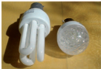
Obrázok 9.4 Philips 11 W vedľa Omicron 1,3 W LED žiarovky.
