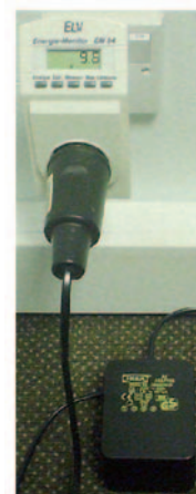
Obrázok 22.1 Nenásytý AC adaptér lampy z obchodného domu IKEA – odoberá takmer 10 W dokonca aj vtedy, keď je lampka vypnutá!
