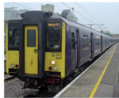
Obrázok 20.4 Osobný vlak s ôsmimi vagónmi z Cambridgea do Londýna spotrebuje pri maximálnej rýchlosti 100 míľ za hodinu (161 km/h) 1,6 kWh na 100 osobo-km , ak je plný.
