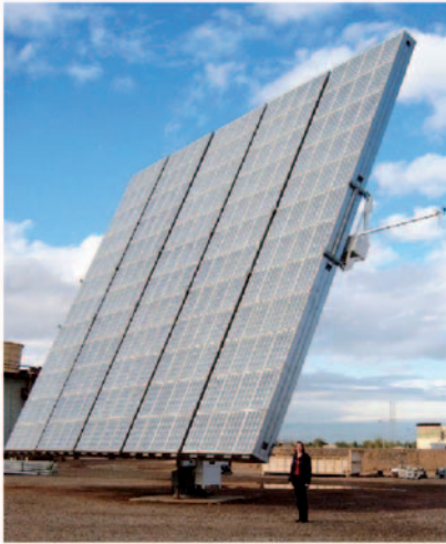
Obrázok 25.9 25 kW (maximum) koncentračný fotovoltaický panel od kalifornského výrobcu Amonix. Jeho 225 m 2 obsahuje 5 760 Fresnelových šošoviek s 260-násobnou optickou koncentráciou, z ktorých každá osvetľuje kremíkový článok s 25 % účinnosťou. Jeden takýto panel, na vhodnej lokalite na púšti, vyrobí denne 138 kWh – dosť pre pokrytie polovice spotreby energie priemerného Američana. Všimnite si človeka pre znázornenie proporcie. Fotografia: David Faiman.
