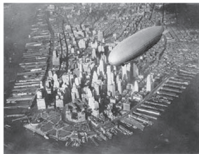
Obrázok C.14 239 m dlhá vzducholode USS Akron (ZRS-4) pri prelete nad Manhattanom. Mala hmotnosť 100 t a uniesla 83 t. Jej motory mali celkový výkon 3,4 MW. Dokázala prepraviť 89 osôb a množstvo zbraní rýchlosťou 93 km/h. Používala sa aj ako vojenský transportér.
