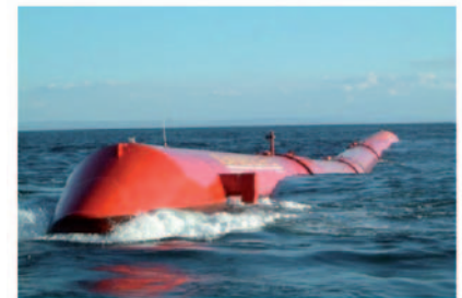
Obrázok 12.1 Kolektor energie vln Pelamis je morský had vyrobený zo štyroch častí. Nosom je nasmerovaný na prichádzajúce vlny. Vlny hada naťahujú. Tomuto pohybu odporujú hydraulické generátory. Maximálna energia z jedného hada je 750 kW; v najlepšej lokalite v Atlantiku by jeden had mohol dodať v priemere 300 kW. Fotografia od výrobcu vlnovej energie Pelamis www.pelamiswave.com .
