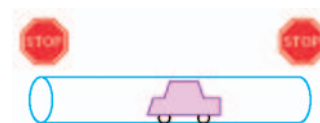
Obrázok A.4 Aby sme zistili, či sa výkon spotrebuje hlavne v brzdnom systéme alebo na prekonanie odporu vzduchu, porovnáme hmotnosť vozidla s hmotnosťou vzduchovej trubice medzi dvomi značkami STOP.
