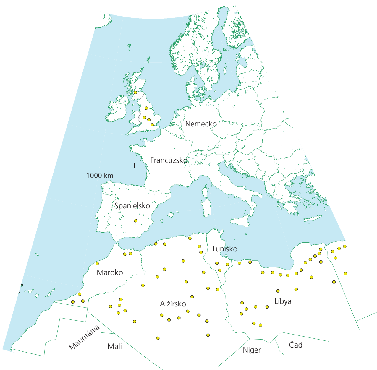
Obrázok 25.8 Každý krúžok predstavuje plochu 1 500 km 2 , z ktorej jednu polovicu vyplňajú zariadenia na výrobu elektriny zo slnečného žiarenia, v priemere 10 GW. 65 takýchto krúžkov by zabezpečilo 1 miliardu ľudí 16 kWh/d na osobu.
