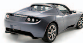
Obrázok 20.22 Tesla Roadster: 15 kWh na 100 km . www.teslamotors.com .
