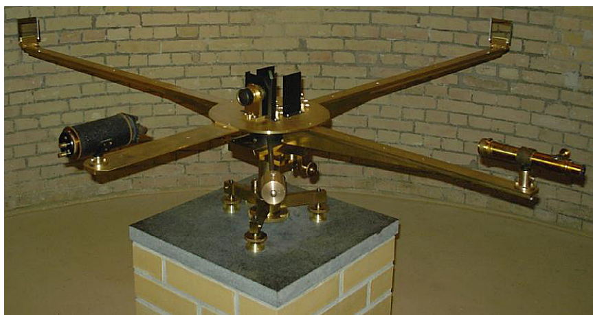
Obrázek 2.10: Skutečný Michelsonův–Morleyův přístroj. Staženo z http://www.aip.de/pr/Michelson.e.html a následně upraveno.
