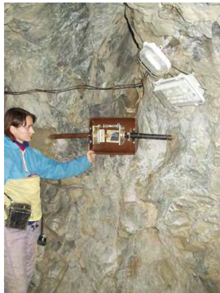
Obr. 5. Deformometr TM – 71 zaznamenávající relativní pohyby podél trhlin ve směrech všech os x, y, z . Příklad na obrázku přepažuje trhlinu sudetského směru v jeskyni Na Špičáku.
