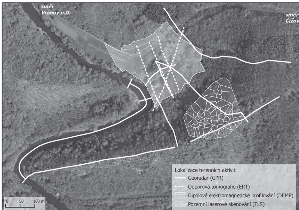
Obr. 1: Lokalizace geofyzikálního průzkumu a pozemního laserového skenování na lokalitě Ledové sluje – Opuštěný meandr, NP Podyjí (Kuda, 2012)
