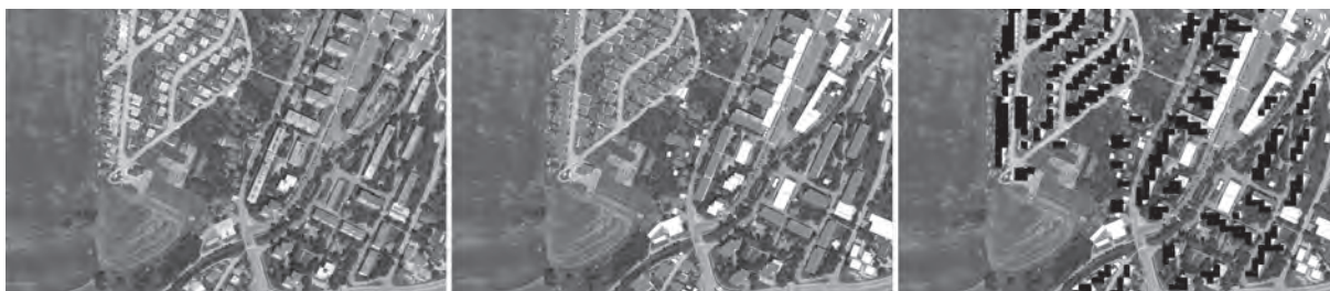
Obr. 5: Problém minimálnej mapovacej jednotky (MMU) na príklade obytných budov; vľavo: letecká snímka znázorňujúca časť intravilánu obce so zmiešanou zástavbou, v strede: vektorová vrstva budov CPD ZB GIS s vyselektovanými obytnými budovami, vpravo: kritériálny raster obsahujúci informáciu o zraniteľnosti obytných budov (cellsize 10)
