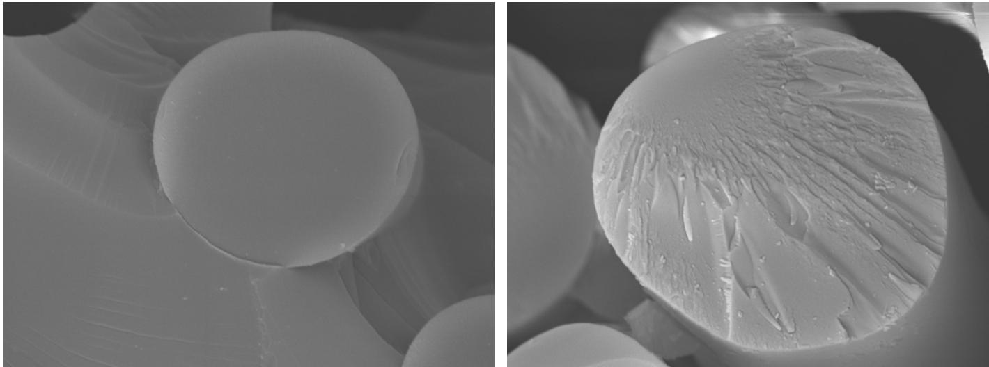
$3 \text{ MPa} \cdot \text{m}^{1/2}$   $\xrightarrow{\text{Vytahování a přemostění trhliny}}$   $15 \text{ MPa} \cdot \text{m}^{1/2}$
