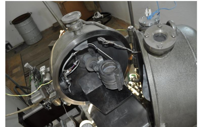
Výzkum termoelastické martenzitické transformace v NiTi slitinách.
