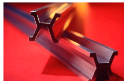
Mezinárodní prototyp metru, 90 % Pt, 10 % Ir. 34
