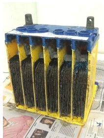
Řez olověným akumulátorem. 58
