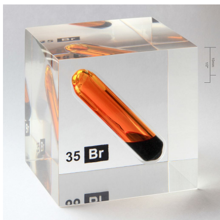
Obrázek 8: Ampule s bromem zalitá do akrylátové pryskyřice
