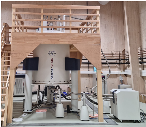
NMR spektrometr 1.2 GHz s kryosondou. 9
