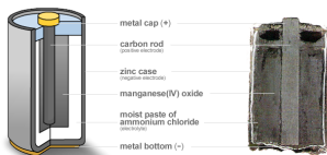
Schéma a řez zinko-uhlíkovým článkem. 16
